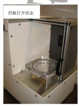
v. 腔体 vent 完成时,系统弹出下图所示的对话框。此时可以打开腔体的盖子。打开腔体,放好样品后点击 "Done",系统就会进行冲洗腔室(purge chamber)的流程。然后回到主界面;如果是刻蚀中途为了查看样品,可以点击 "Examine",系统将抽主腔体真空,但不执行冲洗流程,然后同样的回到下图所示的对话框,等待下一步操作。
