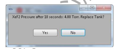
iii. 关闭 XeF2 气瓶手阀并在弹出的如下对话框点击 YES。
