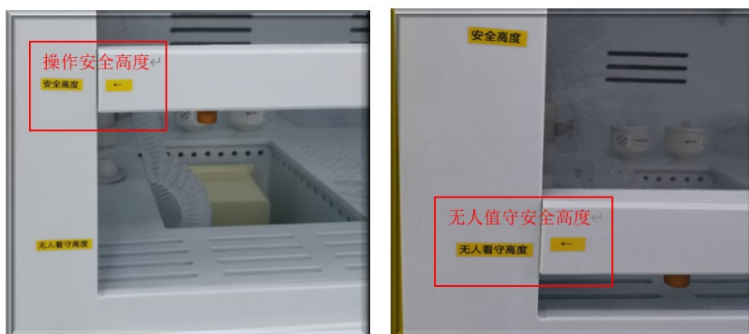
图 5 通风橱面板的规范高度
