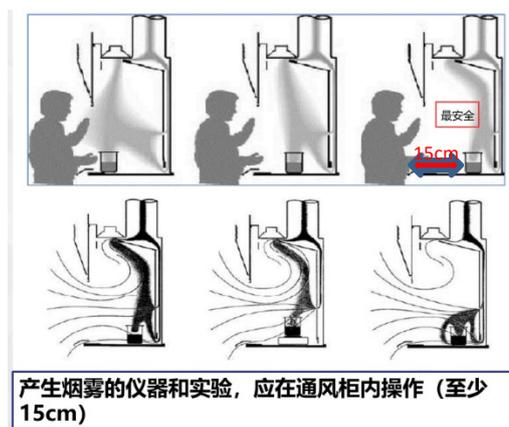
4、 平台通风橱均设置了人员操作时移门**安全高度**和无人看守时移门**无人看守高度**。使用过程中严格按照标识高度使用，平台定义人员离开通风橱操作位置超过**3分钟**，移门应处于无人看守高度。（如下图）
