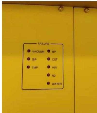
图 2. 设备故障报警显示信息面板
