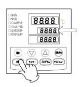
按【定值】键,中央定值画面将显示定值运行,请用 FIX Fill表示
