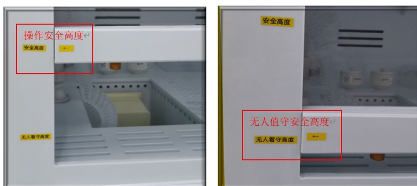
图 5 通风橱面板的规范高度
