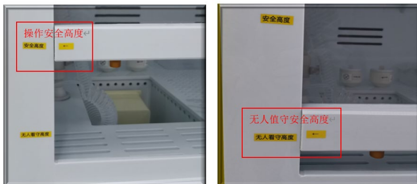
图 4 通风橱面板的规范高度
